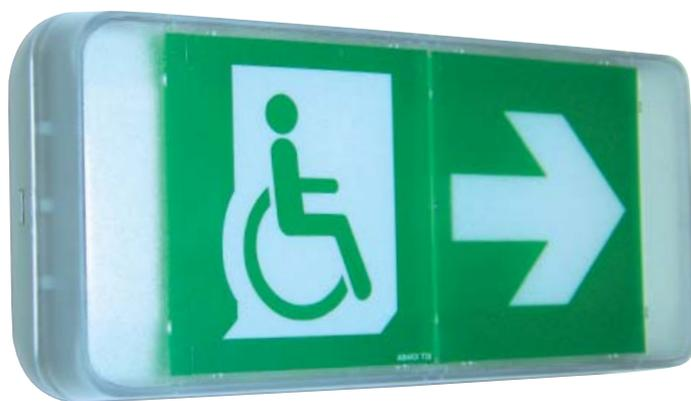
Les installations comprenant des BAES + DBR doivent impérativement être équipées d'une télécommande 94DBR elle-même asservie à l'alarme incendie. Cette télécommande pilotera également les BAES classiques.
